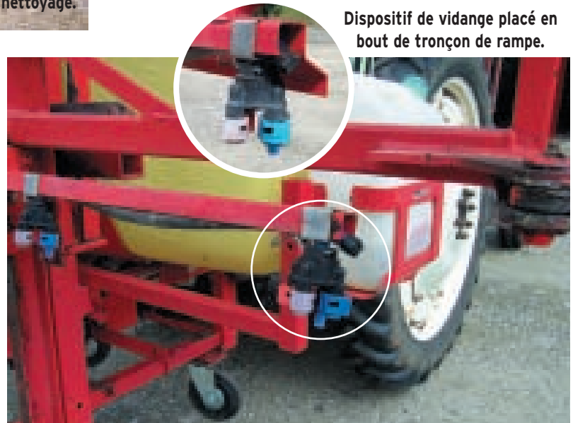
Filtre principal de pompe permettant la vidange du volume mort de la pompe après rinçage et nettoyage.
