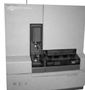
Séquenceur capillaire utilisé pour la lecture des tests SNaPshot.
